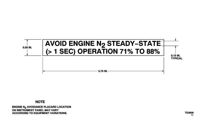
ENGINE N<sub>2</sub> AVOIDANCE PLACARD (269D0302-211) - FABRICATION FIGURE 2
